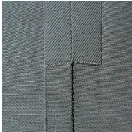
Forsterket rettsøm er en ekstra slitesterk sør og egnet for harde og tette stoffer som jeansstoff og cordfløyel. Ved harde og svært tettvevd stoffer anbefales det å montere Jeansfot #8. Den gjør det lettere å sy jeansstoff eller seilduk. For dekorative stikninger kan man i tillegg øke stinglengden.
