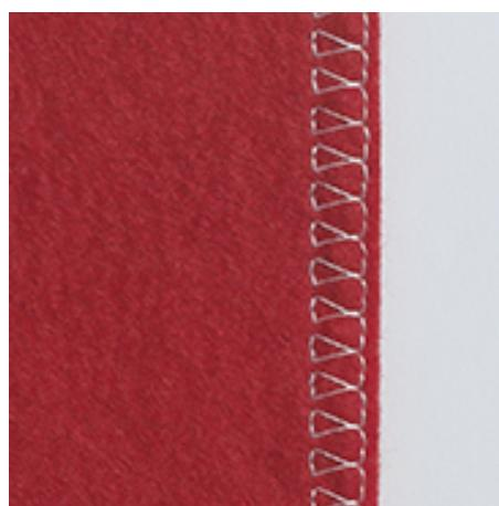
Lukket overlocksøm passer til løse strikkede stoffer og tversømmer i strikket stoff. En ny jerseynål bør brukes på strikkede stoffer, slik at ikke de fine maskene skades. En stretchnål kan brukes ved sying av elastiske stoffer.
